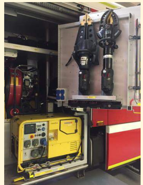
RW 2.1. Hydraulischer Rettungssatz eingebaut
